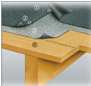
1. Protan SE 1,6 mm 2. Kiinnike 3. Suodatinkangas 4. Ponttilauta, vaneri tai vastaava
